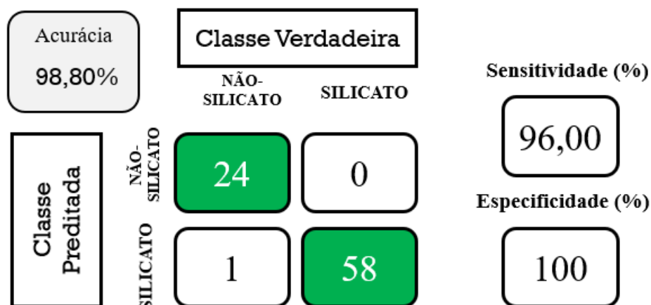
Figura 35 - Matriz de confusão para o classificador Fine KNN, após a seleção de componentes principais. Classe mineral Silicato versus não-silicato, para as amostras de treinamento. Os valores de acurácia, sensibilidade e especificidade são mostrados em porcentagem.
