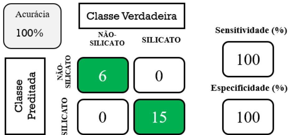
Figura 38 - Matriz de confusão para o classificador Fine KNN , após o processo de otimização de PC's. Classe mineral Silicato versus não-silicato, para as amostras de validação externa. Os valores de acurácia, sensibilidade e especificidade são mostrados em porcentagem.
