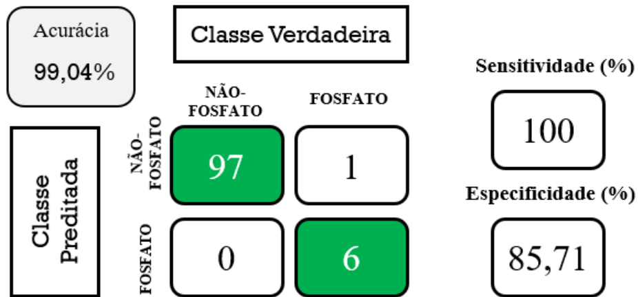
Figura 32 - Matriz de confusão para os classificadores KNN e SVM , após a seleção de componentes principais. Classe mineral Fosfato versus não-fosfato. Os valores de acurácia, sensibilidade e especificidade são mostrados em porcentagem.
