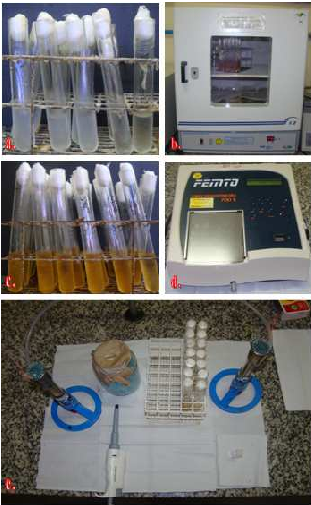
Figura 4 - a) soluções salinas com os inóculos microbianos.; b) estufa microbiológica onde foram armazenados os ensaios.; c) tubos contendo cimentos + meio líquido + microorganismo; d) Espectrofotômetro.; e) meio estéril onde foi realizado todo o experimento
