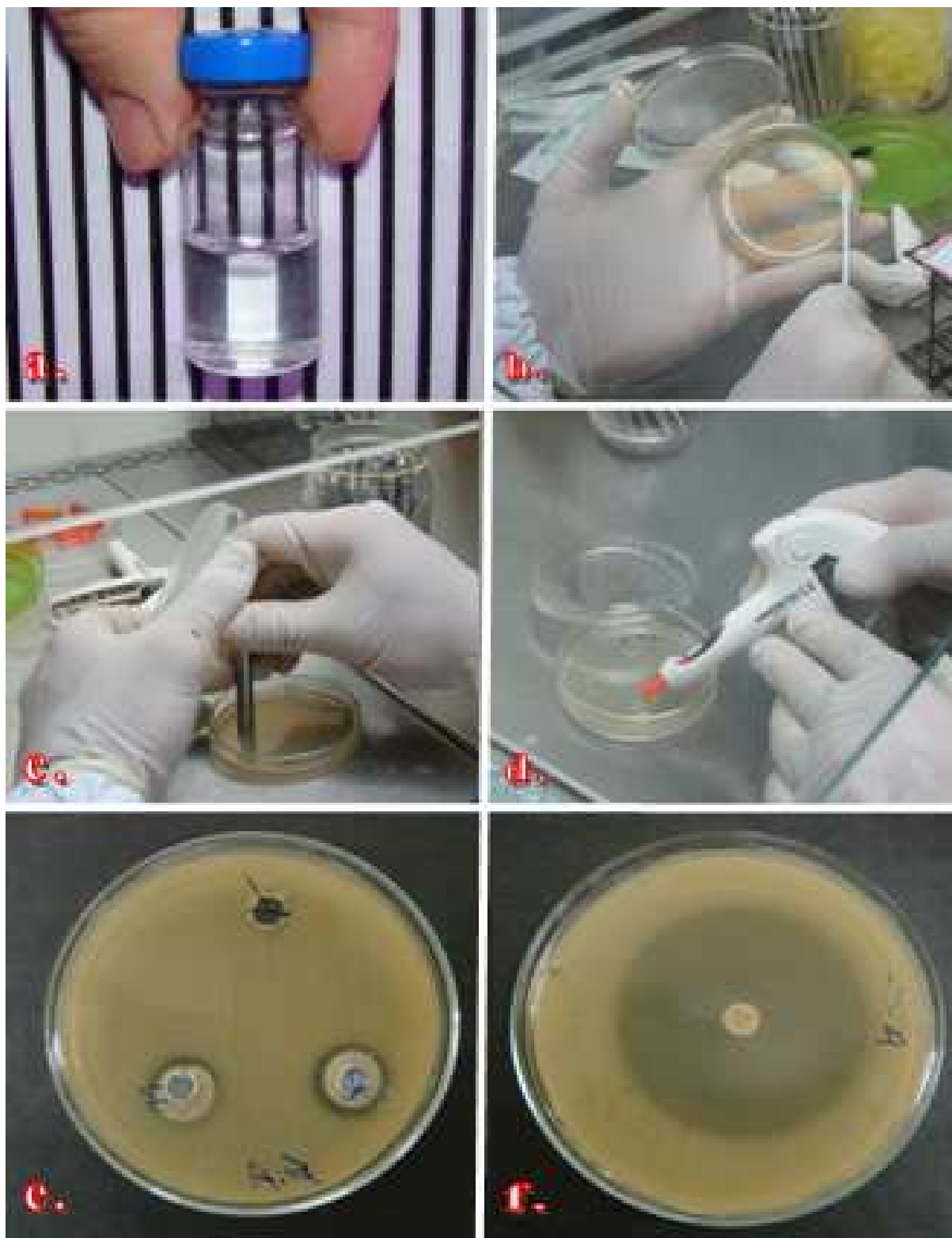
Figura 3 - a) Escala de McFarland mostrando turbidez do meio; b) inserção das suspensões microbianas na superfície do ágar Mueller Hinton; c) Confecção dos poços para posterior colocação dos cimentos; d) inserção dos cimentos; e) Placas mostrando a análise dos halos de inibição frente à três cimentos endodônticos; f) Placa demonstrando o halo de inibição do controle positivo Vancomicina.
