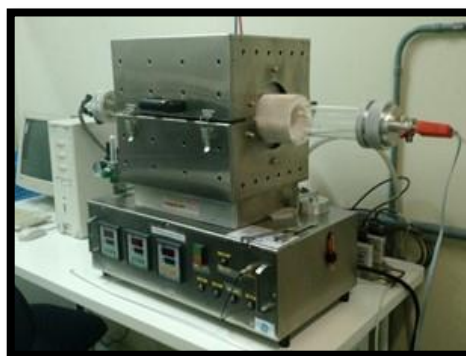
Figura 17 - Forno tubular bipartido que permite controlar a atmosfera sobre o qual as amostras foram tratadas termicamente. (A autora)
