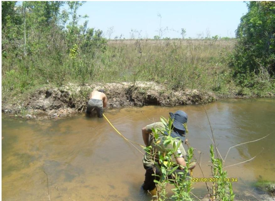
**Figura 05. Medição do perfil transversal do canal fluvial no Córrego Moeda.**
