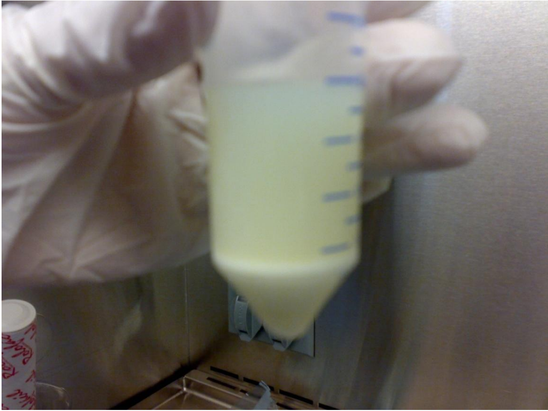
Figura 4 – Tubo cônico de plástico mostrando o precipitado de lactose evidenciado pela cor branca.
