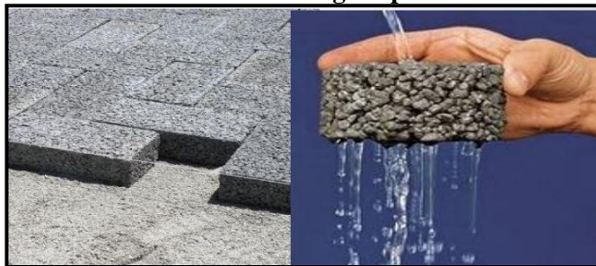
Figura 79 - Demonstração de Perfil de Pavimento Poroso que pode ser implementado para facilitar o escoamento das águas pluviais.
