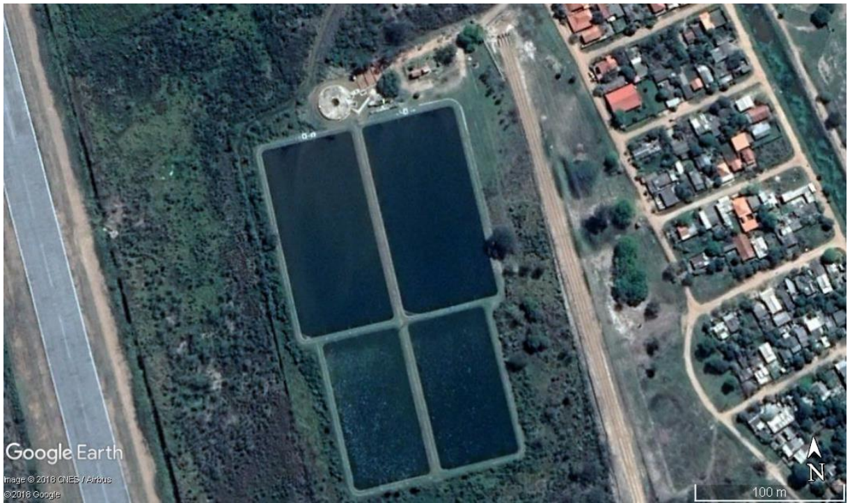
Imagem - ETE 2C Lagoa Facultativa + Lagoa de Maturação, vazão de projeto = 36 \text{ L}\cdot\text{s}^{-1} .
