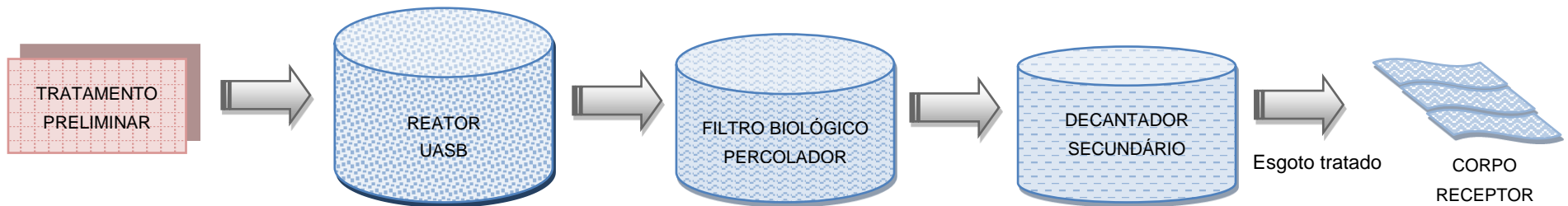
Figura 4.7. Fluxograma da Tecnologia 5: Tratamento Preliminar + Reator UASB + Filtro Biológico Percolador + Decantador Secundário.
