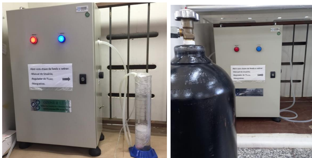
Figura 5 – a) Procedimento de degradação do MeP no ozonizador; b) Composição do ozonizador
