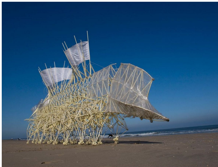
Figura 1.3. O terrestre Umerus em PVC, abraçadeiras de náilon, plástico, dracon, cordas e garrafas SPA, de 4x1,2x2 m, sobre a areia de Theo Jansen
