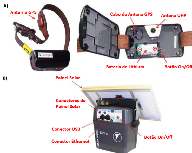
Figura 5.2: O Colar GPS (A) e a Estação Base que armazena os dados dos colares (B).
