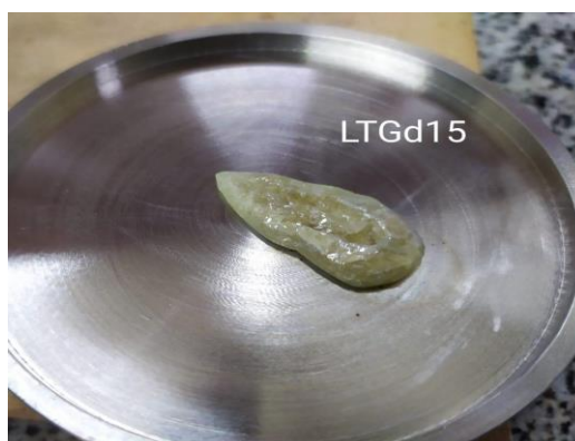
Figura 7 - Amostra LTGd15, produzida a partir do processo de splat-cooling.
