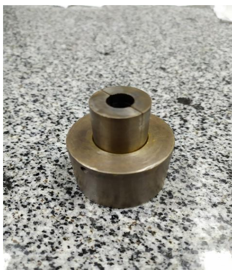
Figura 3 - Molde utilizado para o processo de resfriamento.
