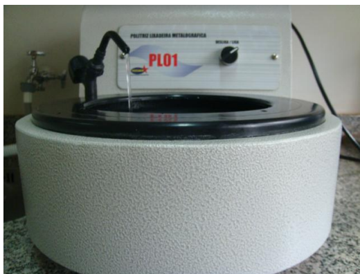
Figura 17 – Politriz metalográfica utilizada para planificação e polimento dos espécimes.
