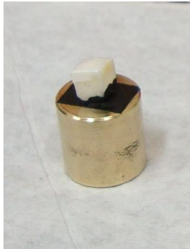
Figura 19 – Espécime fixado em stub com auxílio de fita dupla face e tinta condutora de prata.
