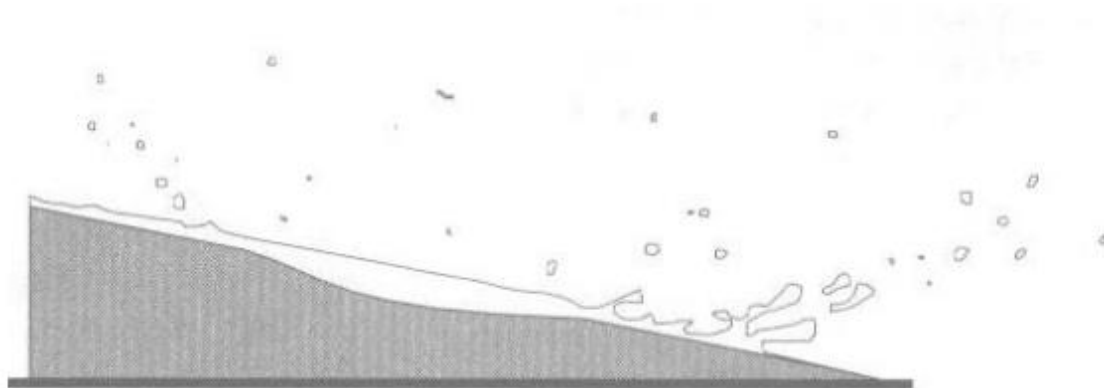
Figura 5: Exemplo de salpicamento ocasionado pela Erosão Hídrica
